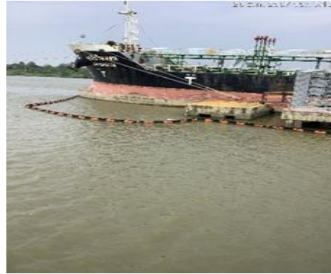
ภาพที่ 2-6 การล้อมทุ่น (Boom) รอบลำเรือบรรทุกน้ำมัน
