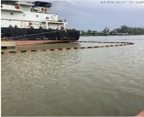
ภาพที่ 2-6 การล้อมทุ่น (Boom) รอบลำเรือบรรทุกน้ำมัน
